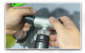
NOW INSERT THE FACTORY BUSHINGS AND SLEEVES INTO YOUR NEW UPPER AND LOWER HD A-ARM COLLARS.
