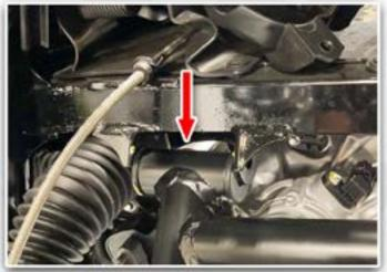
INSTALL THE UPPER ARM AT THE FRAME USING THE FACTORY (17MM) NUTS, BOLTS AND WASHERS.
